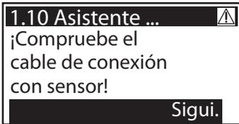
Para localizar el error, el regulador recomienda aquí comprobar el cable de conexión.
