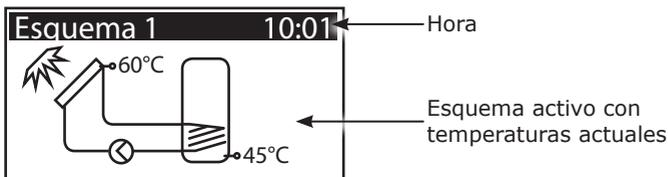
Elementos de visualización con ejemplo de pantalla de comunicación
