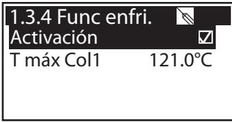
Aquí se activa el enfriamiento de colector: cuando se alcanza la temperatura de colector >T máx Col1< la bomba del circuito solar se pone en marcha hasta que se alcanza la temperatura límite de depósito.
