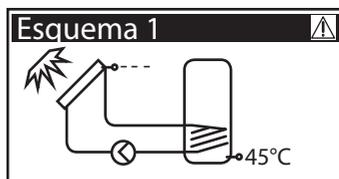
Si en la pantalla se lee ›Función de seguridad‹, se trata de un mensaje, no de una avería.
