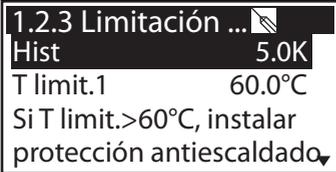
Si en el Depósito 1 la temperatura aumenta por encima del valor  $>T\text{-límit.1}<$ , es imprescindible apagar la bomba de circuito solar. La bomba no se conecta de nuevo hasta que el valor  $T$  límite está por debajo de la histéresis  $>Hist<$ .
