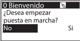
Aquí es posible iniciar una nueva puesta en marcha , p.ej. si es necesario seleccionar un nuevo esquema hidráulico.
