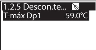
Temperatura máxima del depósito 1, para evitar que el agua se caliente demasiado en el depósito, éste se carga solamente hasta su  $>T$  máx Dp $<$ .
