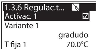
Si en >1.3.7 Parámetro de< se definieron algoritmos de regulación con >T fija<, aquí se pueden configurar las salidas correspondientes.
