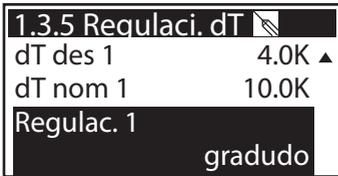
Con >dT act< se determina la temperatura de conexión, con >dT des< la temperatura de desconexión y con >dT nom< la temperatura diferencial nominal. (temperatura diferencial entre colector y depósito inferior).
