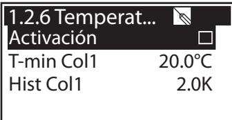
Para mejorar la eficiencia en la carga de los depósitos, con  $>T$  mín col $<$  se introduce la temperatura mínima que debe haber en cada colector.
