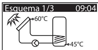
El regulador ofrece ahora los esquemas hidráulicos posibles atendiendo a las interfaces asignadas. Dando vueltas al codificador giratorio se selecciona el esquema deseado (aquí, esquema 1 de entre 3 posibles) y se confirma con el pulsador >OK<.
