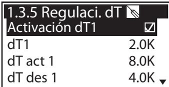
Si en >1.3.7 Parámetro de< se definieron algoritmos de regulación con >dT<, aquí se pueden configurar las salidas correspondientes.
