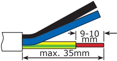
La descarga de tracción solamente puede asegurar una sujeción estable si no se quitan más de 35 mm del aislamiento de los cables.
