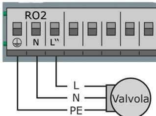
Schema di collegamento di una valvola di commutazione con alimentazione di tensione a RO2:
