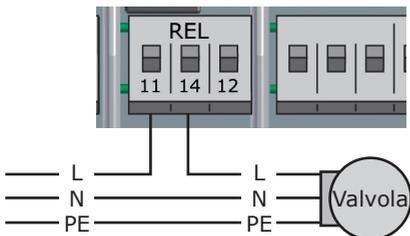
Schema di collegamento di una valvola di commutazione con alimentazione di tensione a REL:
