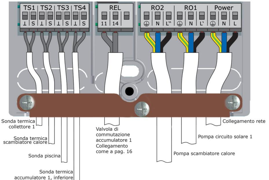
Le funzioni per il controllo della caldaia sono espletate attraverso il contatto a relè privo di potenziale, collegato alla relativa interfaccia della caldaia.
