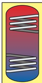
Accumulatore acqua calda/tampone con scambiatori di calore
