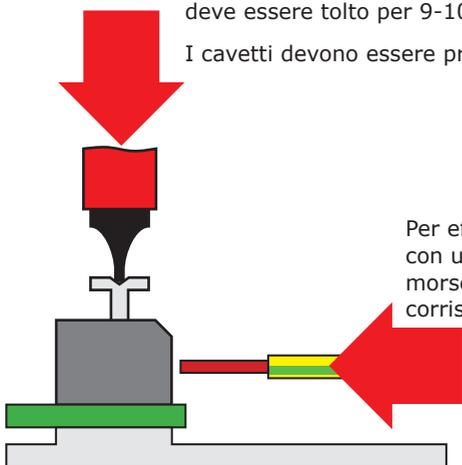
Per effettuare il collegamento, premere con un cacciavite il tasto di azionamento del morsetto a molla e inserire il filo nell'apertura corrispondente fino alla battuta.
