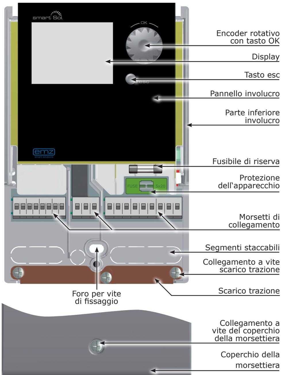
La messa a punto e l'impiego del regolatore di temperatura differenziale **smart Sol** avvengono interamente tramite due soli elementi di comando, situati sul lato anteriore dell'apparecchio.
