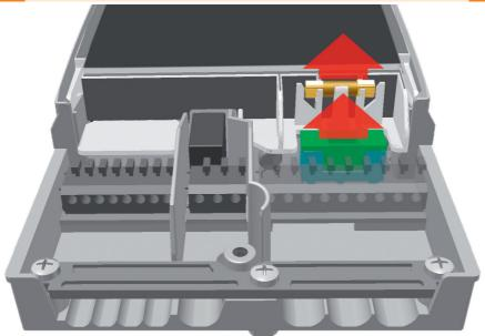
Pour démonter le fusible de l'appareil, ouvrir le couvercle de la boîte à bornes. Au-dessus du groupe de bornes droit, le socle de fusibles et un fusible de réserve sont disposés. Retirer la partie supérieure du support et la pièce de rechange. La cartouche-fusible est serrée dans la pièce moulée et est retirée avec le support en plastique.
