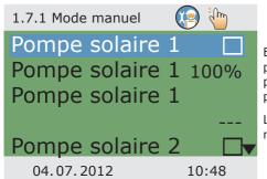
En mode manuel, les sorties individuelles peuvent être activées à des fins d'essai, par exemple afin de vérifier si une pompe fonctionne correctement.
