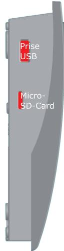
Le régulateur solaire est équipé des interfaces de données suivantes :
