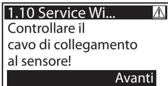
Il regolatore indica qui di controllare il cavo di collegamento per trovare l'errore.
