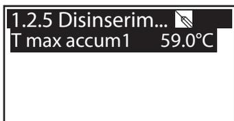
Temperatura massima del accumulatore. Per evitare che l'acqua nell'accumulatore sia troppo calda, questo viene riempito solo fino al raggiungimento della sua >T max<.
