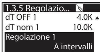
Se in >1.3.7 Parametri uscita< sono stati definiti algoritmi di regolazione con >T fissa<, qui si possono configurare le relative uscite.
