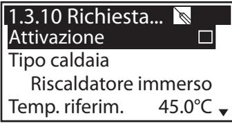
Qui viene attivato il riscaldamento integrativo. La caldaia viene definita come >Riscaldatore immerso< oppure >Gas/Olio<. Se il valore >Temp. riferim< della sonda termica dell'accumulatore superiore dovesse essere inferiore al valore di >isteresi<, il comando attiva il riscaldamento integrativo mediante la caldaia fino a quando non sia stato raggiunto il valore >Temp. riferim<. Continuare con >Funzioni protezione<.
