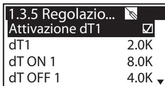
Con >dT ON 1< viene impostata la temperatura di inserimento, con >dT OFF 1< la temperatura di disinserimento e con >dT nom 1< il gradiente termico nominale per il circuito solare.
