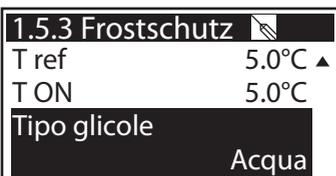
Se vengono impiegati antigelo, è possibile immetterne il tipo e la percentuale, e la temperatura antigelo viene calcolata automaticamente.
