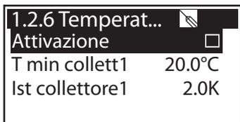
Per aumentare l'efficienza della produzione di acqua calda per l'accumulatore, con >T min coll< viene immessa la temperatura minima che deve essere presente nel collettore corrispondente. Il relativo valore di isteresi rappresenta la differenza tra la temperatura di inserimento e quella di disinserimento.
