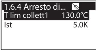
Con >t lim coll1< viene spenta la pompa di circuito solare, per evitare un danneggiamento.
