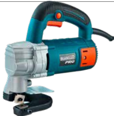
BMC8500 Ψαλίδι λαμαρίνας • Ισχύς 850W • Στροφές 1600rpm • Πάχος κοπής 3.2mm
